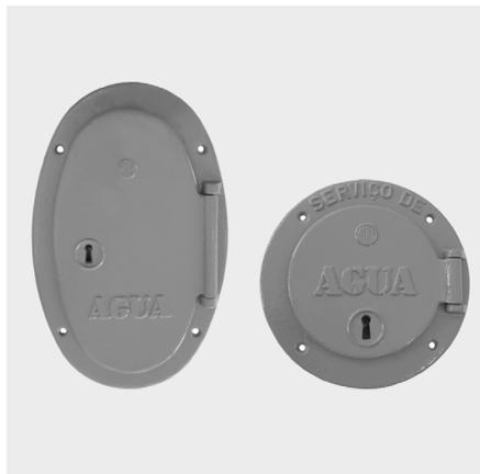
Em ferro fundido EN: 1561 e pintadas em esmalte cinzento RAL 7046. Fecho com mola em inox, lingueta em latão e espelho em aço cadmiado. As dobradiças em cavilhas elásticas permitem a substituição da porta sem descravar o aro.
